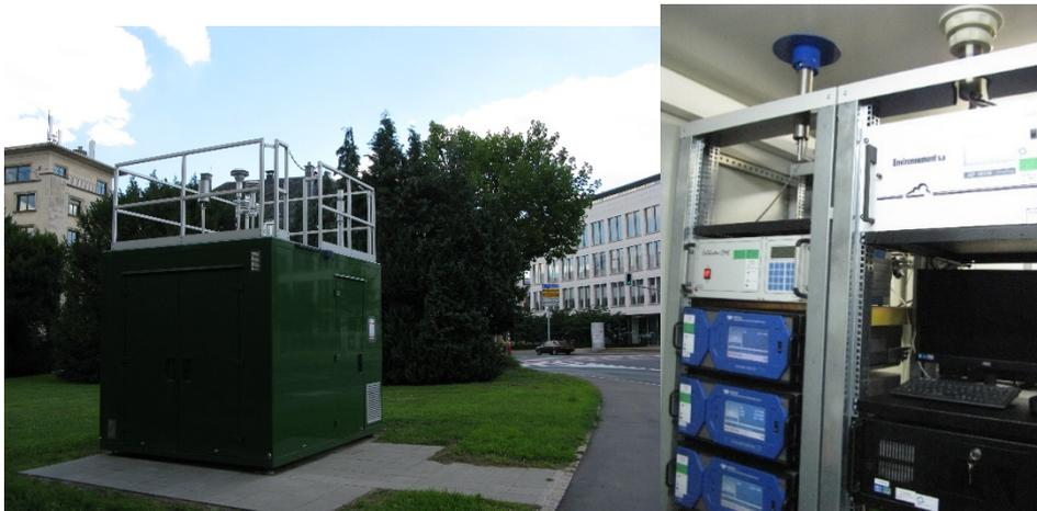
**Messstation und Probenahmestellen zur Bewertung der Luftqualität (blaue Geräte auf dem Foto rechts).**
